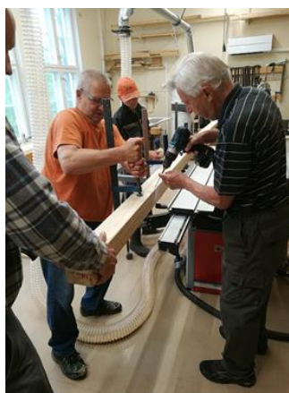
Jalat tehtiin kahdesta 50x100 mm lankusta, joiden keskelle työstettiin kevennys.
