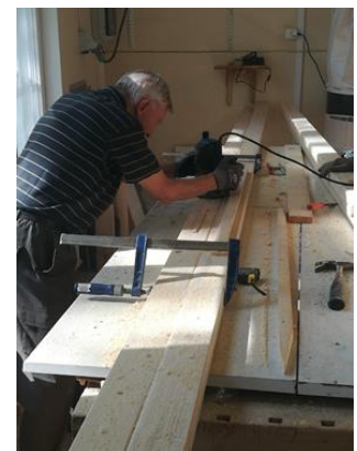
Jalat tehtiin kahdesta 50x100 mm lankusta, joiden keskelle työstettiin kevennys.
